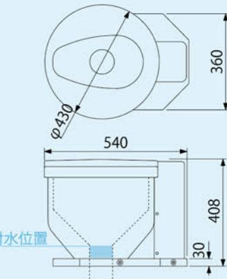
**KS-S117S トランプ内蔵・壁給水・床置型 洋風便器**
