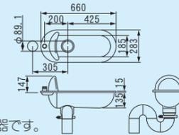
ステンレス製で壊されにくい和風大便秘器です。寒冷地における凍結でもひび割れることはありません。清掃もしやすく、特に太いトラップを採用しているのが物が詰まりにくい構造になっています。トラップもステンレス製なので打ち抜かれる心配はありません。
