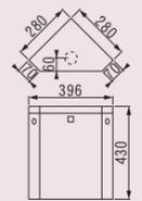
蓋がはずれにくく、盗難やイタズラをされにくい構造の貯水槽です。ボールタップ、排水弁、グロメットが付属します。
